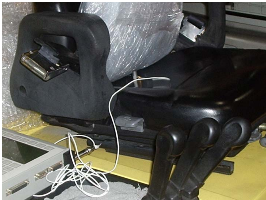
Figura 2 – Posição no eixo z para avaliação de vibração no corpo inteiro.
